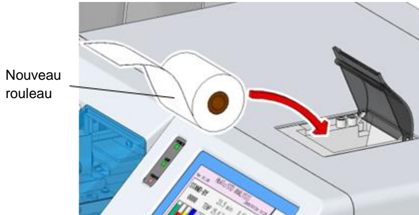
Fig. 5-3 Mise en place d'un nouveau rouleau
